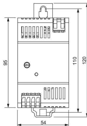
Wandmontage-Kit integrierte abnehmbare, für die Schrauben 4mm.
